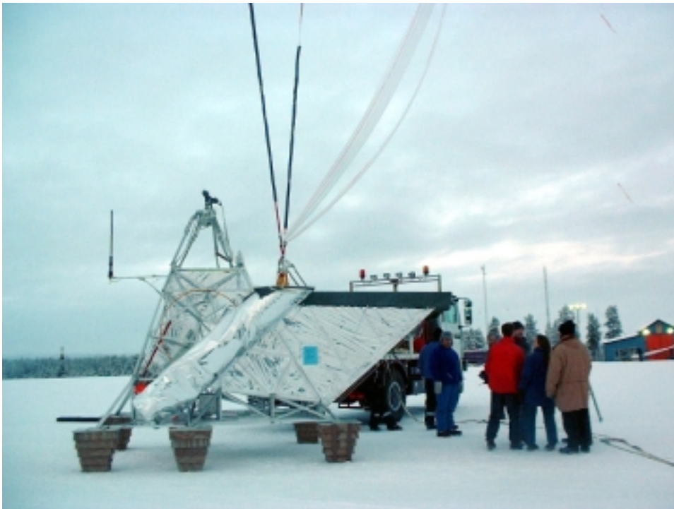
Figura 4.3: Fotografia del payload subito prima del lancio (29 Gennaio 2001). Sopra la gondola si nota la struttura leggera che collega la gondola al pivot, e sul fianco della gondola il telescopio stellare.
