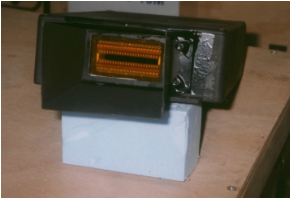
Figura 3.24: Fotografia della finestra dei sensori (è visibile l'array di 46 fotodiodi) con il filtro Schott OG530 montato. Questo è il filtro scelto per il volo di Kiruna per ottimizzare il numero di stelle visibili nelle ore diurne.
