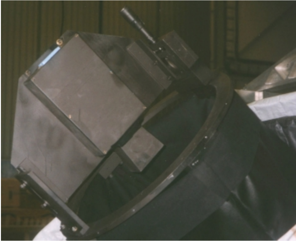
Figura 3.20: Fotografia della scatola dei sensori montata sul telescopio con il supporto per il fuoco; è visibile lo schermo attorno alla finestra rivolta verso lo specchio.
