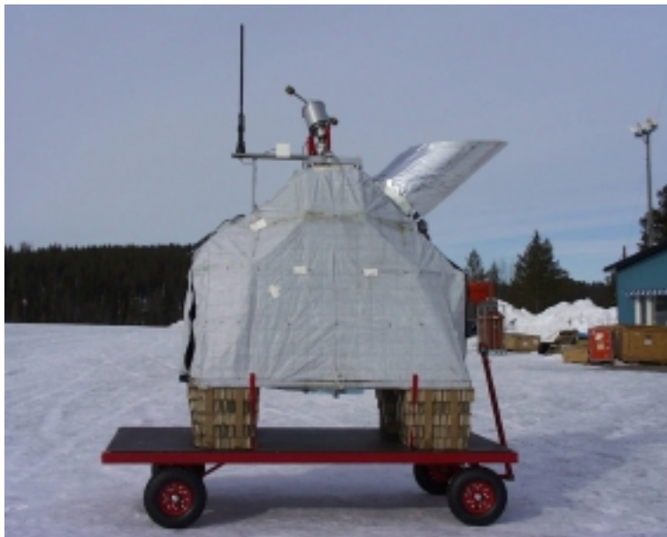
Figura 2.11: Fotografia della gondola utilizzata nel volo di Aprile 2000, per provare le prestazioni del sensore stellare (del quale si vede sporgere lo schermo anteriore dalla gondola, sulla parte destra dell'immagine) dopo alcuni cambiamenti.
