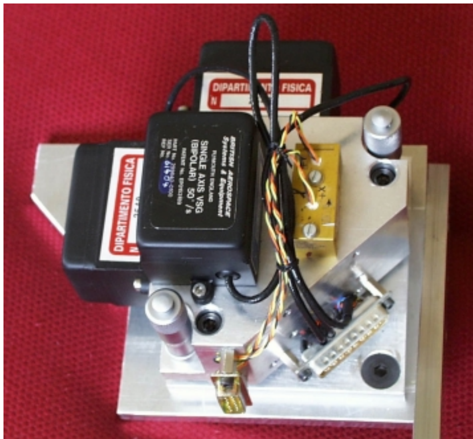
Figura 3.44: In questa foto sono visibili i tre giroscopi utilizzati come sensori di rotazione della navicella. Essi sono montati secondo tre assi ortogonali su una base che ne permette l'allineamento con la gondola; una livella elettronica permette la regolazione precisa dell'asse verticale. Inoltre il tale supporto, progettato nell'ambito di questa tesi, permette ai sensori di rimanere a temperatura costante (grazie all'uso di resistenze di riscaldamento), poichè il segnale dipende molto dalla temperatura.
