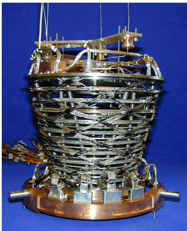
FIG. 3.8 – Photographie du modèle de qualification réalisé à l'Air Liquide. Sur cette photographie la base se trouve en haut et le point froid en bas. Les fils électriques sont thermalisés le long de l'échangeur afin de minimiser les pertes thermiques.
